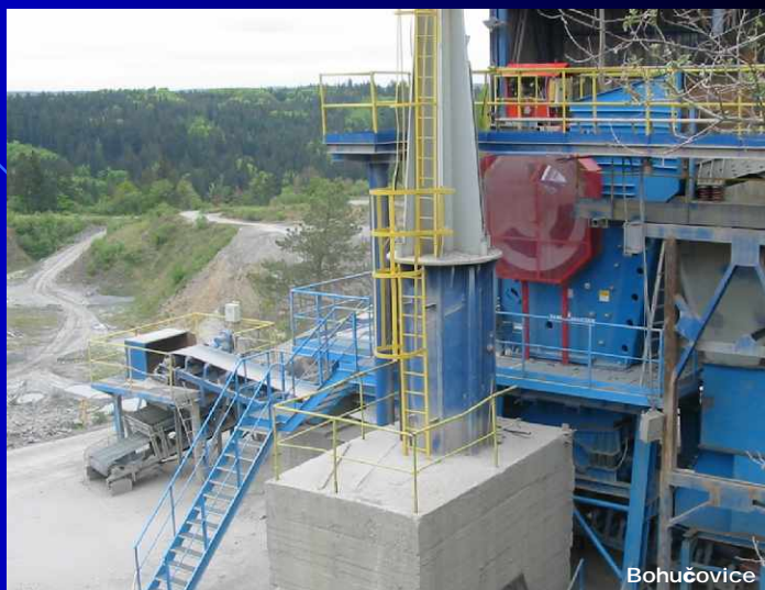
vibrační podavač VZP 140.025 pod drtičem
