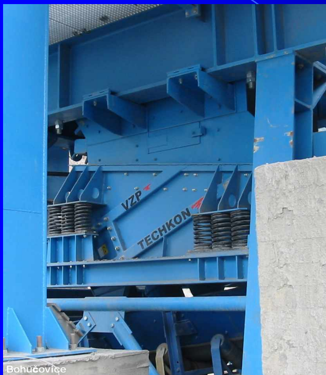
vibrační podavač VZP 140.025 (detail z obrázku vpravo)
