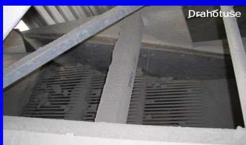
detail prstového třídíče TORNÁDO MP z SMP 080.3
