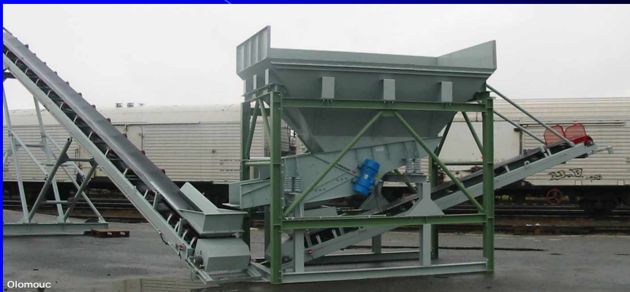
semimobilní třídírna SMP 080.2 s prstovým třídícím TORNÁDO MP
