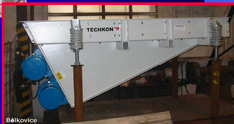
vibrační podavač VZP 080.025 Z
